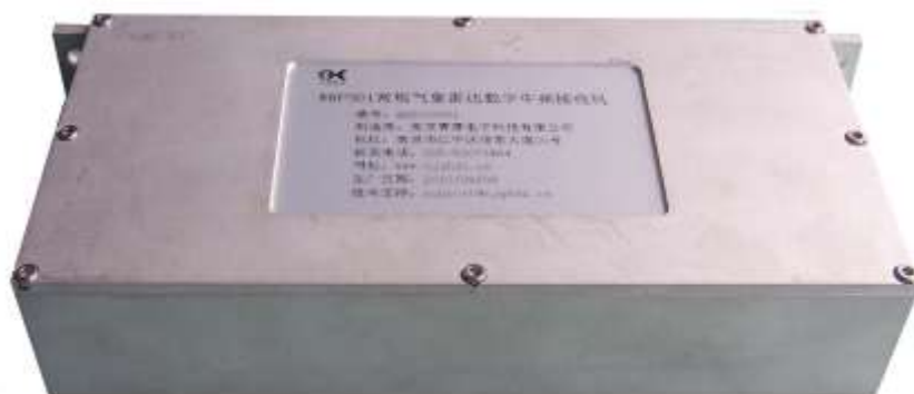
图 3-1 数字中频接收机的外形照片
